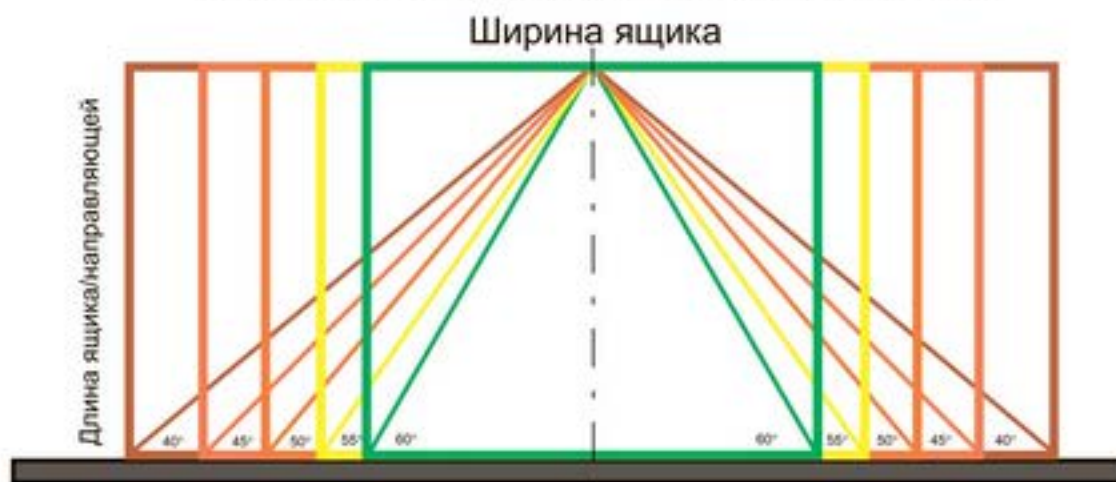
Стабильность срабатывания механизма Push в зависимости от габаритов ящика при воздействии на фасад.
